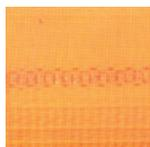
Manguera BLINDEX tras 10,000 horas de envejecimiento acelerado.
