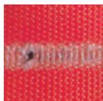
Manguera en caucho sintético SBR. Envejece y revienta incluso un abrasión tras un periodo moderado.
