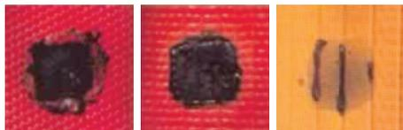
Comparativamente a las mangueras existentes en el mercado, sean resinadas o recubiertas de caucho, la manguera BLINDEX soporta mejor las altas temperaturas. La prueba de las fotos se hizo con un dado de acero a 600° c.
